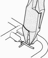
★接着面の大きい部品は組み合わせておいて流し込みタイプ接着剤を使用するとよいでしょう。
