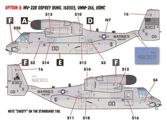
THIS DIAGRAM SHOWS THE PAINT SCHEME AND COMMON STENCILLING USED ON USMC OSPREYS. THE FADED BLUE NATIONAL INSIGNIA (N7-N8) IS UNIQUE TO OPTION 3.
