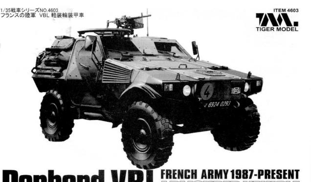
PANHARDVBLはフランス陸軍現役(1987-現在)軽装甲偵察車(装輪)であり、フランス PANHARD会社より設計、製造された。4×4のドライブ方式で車の機動性及びクロスカント リー性が高い。前輪はダブルーウィッシュボーン式サスペンションを用いるが、後輪はタン クしか利用しないトーションバー式サスペンションを採用するのが特別である。側面から見 ると、車の後輪は同一の直線ではない。VBLの車体は、高強度、高硬度な鋼製装甲溶接 技術構造を採用し、厚さは5-115mmであり、近距離内で7.62mmの徹甲銃弾の攻撃に抵 抗できる。ガラス窓は、厚さ33-49mmの防弾ガラスで作成され、防弾機能が付いている。 その他、車の後部にプロペラ式の水上推進装置が整備される。水上で運転する場合、前 部の防波板を縦にし、水上最大速度は4km/hになる。
