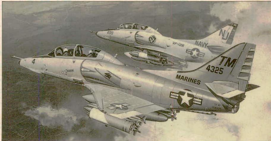
TA-4Fはアメリカ海軍がグラマンTF-9J高等練習機の後継機として発注したA-4スカイホークの複座型練習機です。機体の変更点は、複座化に伴い胴体を2ft 4in(約71cm)延長した他に、APG-53A地形回避レーダー、APN-141電波高度計、APX-64IFF、ARA-50ADF、ASN-41航法システム、AJB-3A爆撃システム等を装備、前脚にはステアリング機構を取り入れ、タキシング中の方向変換を容易に行える様に改善されていました。現在これらの機体はほとんどがTA-4J、OA-4M等に改修され、標準型のTA-4Fは姿を消しつつあります。
